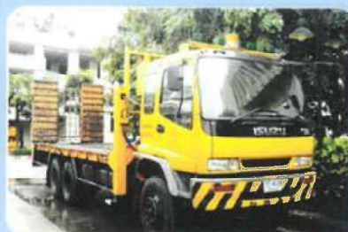
รถบรรทุกเครื่องจักรกลขนาดน้ำหนักบรรทุกเกิน ๑๐ ตัน ไม่เกิน ๒๐
